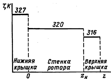
Рис. 4.18. Оптимальные тепловые граничные условия на крышках и стенке ротора
